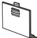
Druk het geribbelde gedeelte in en schuif de afdekking naar buiten om het batterijvak te openen.
